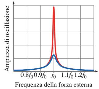
**Figura 10.28** Due curve di risonanza per un oscillatore con frequenza naturale  $f_0$ . L'ampiezza della forza esterna è costante. Nel grafico in rosso, lo smorzamento dell'oscillatore è un quarto di quello nel grafico blu.
