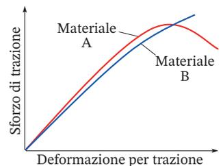
**Figura 10.6** Grafici sforzo-deformazione per due distinti materiali.
