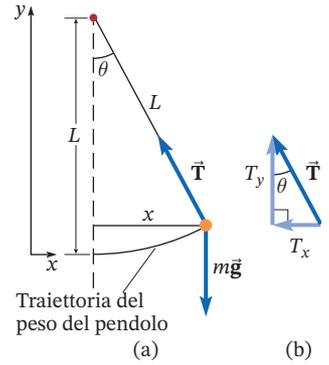
**Figura 10.23** (a) Le forze sul peso di un pendolo. (b) Come ricavare la componente  $x$  della forza dovuta al filo.
